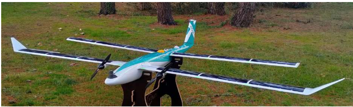
Figure 4 : Drone de surveillance longue endurance à énergie solaire de chez Xsun
