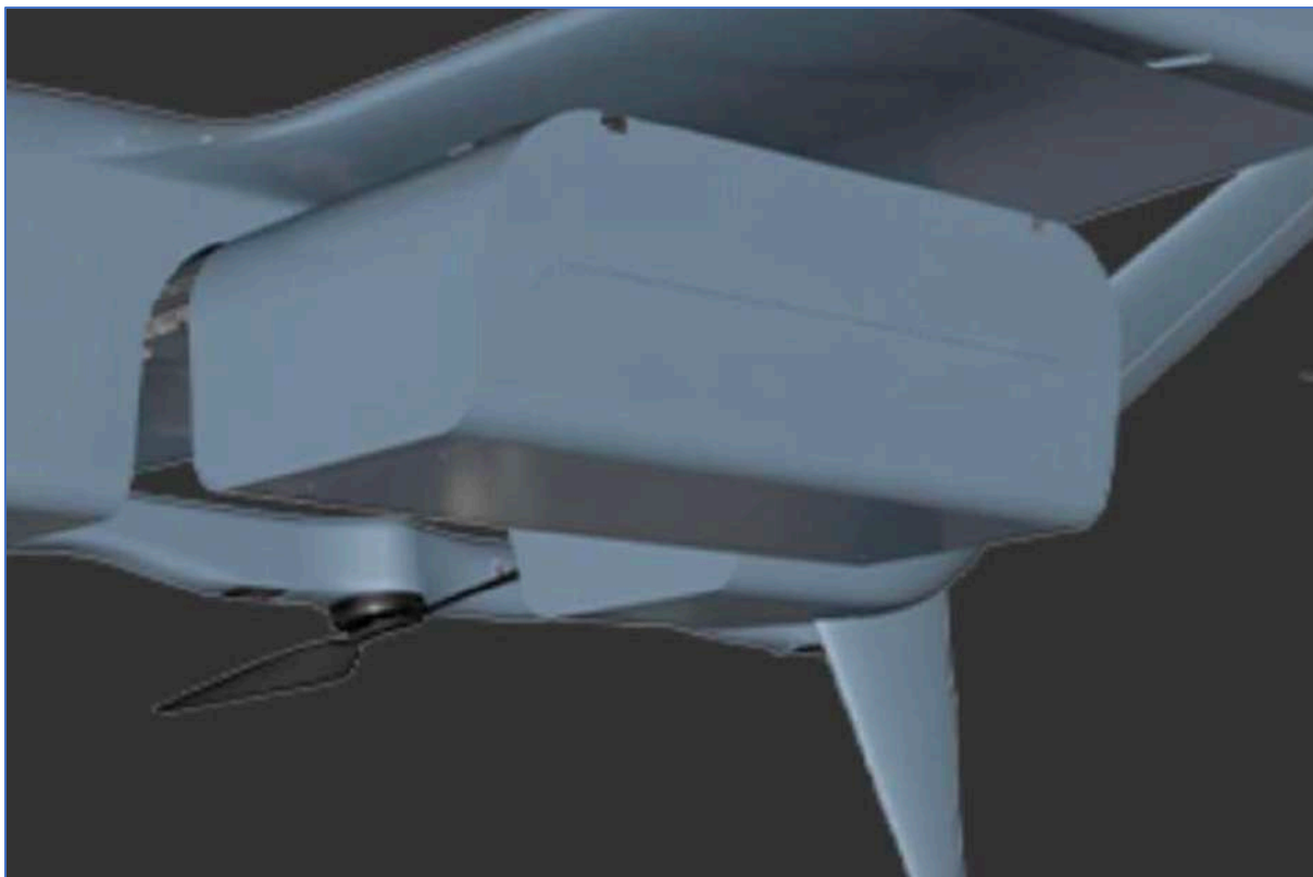
Figure 6 : Espace de chargement cloisonné avec balance
